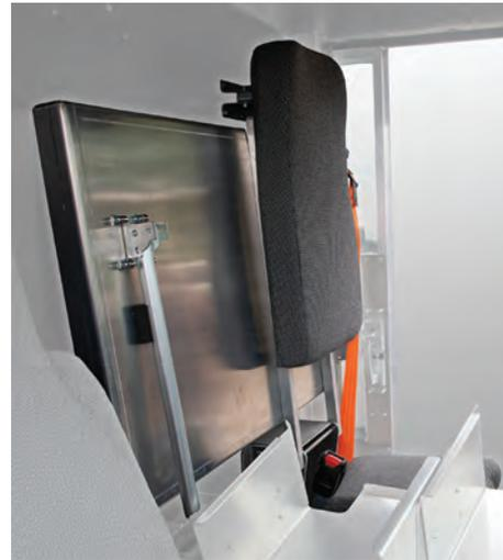
Ce véhicule peut être équipé d'un plateau de courrier rabattable et d'un dossier passager dans la cabine au lieu d'un VTS. Un plateau de courrier rabattable et un dossier passager sont situés au centre et sur le côté de la route de la cabine. La jambe de soutien doit être rabattable lorsque le bac à courrier est utilisé et rangée lorsque le plateau est plié contre le mur de la cloison.
