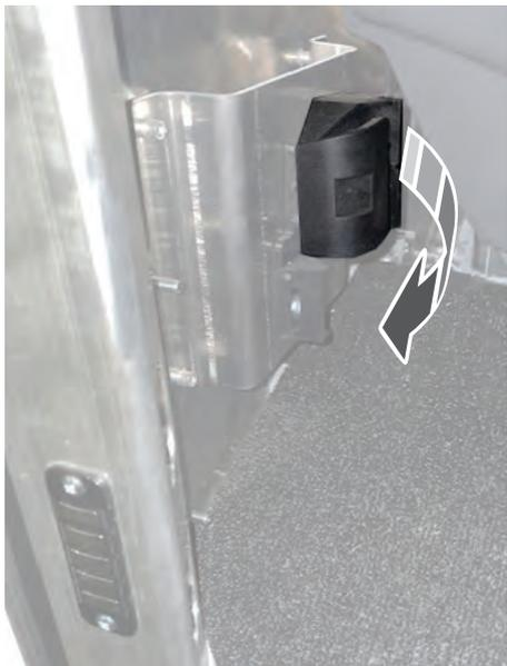
2. Tirez le levier de dégagement secondaire sous l'avant du capot, au-dessus de la grille près du centre de votre véhicule. Soulevez le capot.
