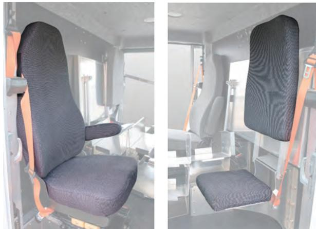
Les appuie-tête sont intégrés dans les sièges. Aucun ajustement n'est requis. Pour aider à minimiser le risque de blessure au cou en cas d'accident, nous vous recommandons de vous asseoir en position verticale avec la base de votre colonne vertébrale aussi loin que possible. Assurez-vous de rester à l'aise.
