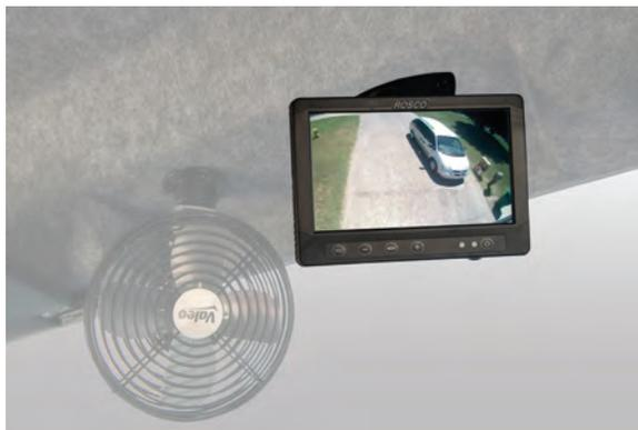
Le moniteur de la caméra de recul est situé au-dessus du pare-brise. Le moniteur fournit une image vidéo de la zone arrière votre véhicule lorsque la transmission est en marche arrière (R). Une caméra de vue côté route fournit également une image vidéo de la zone du côté de la route de votre véhicule lorsque le clignotant gauche est activé. *Voir la page 26 pour l'emplacement de la vue arrière et des caméras côté route.*
