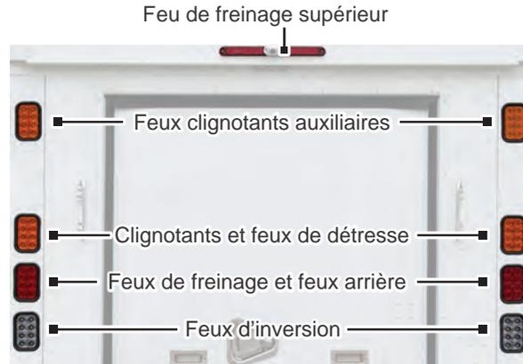
**Feu de freinage supérieur** - S'allume en tout temps pendant que le véhicule est allumé. Les lumières s'allument lorsque les freins sont serrés.
